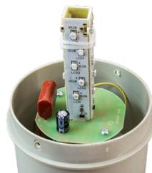
Рис. 1 – Платы управления со светодиодами
